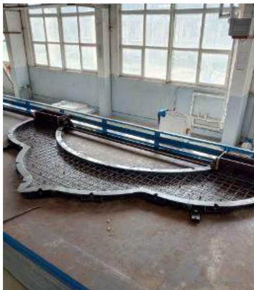
Фронтон, изготовлен на поворотном столе
