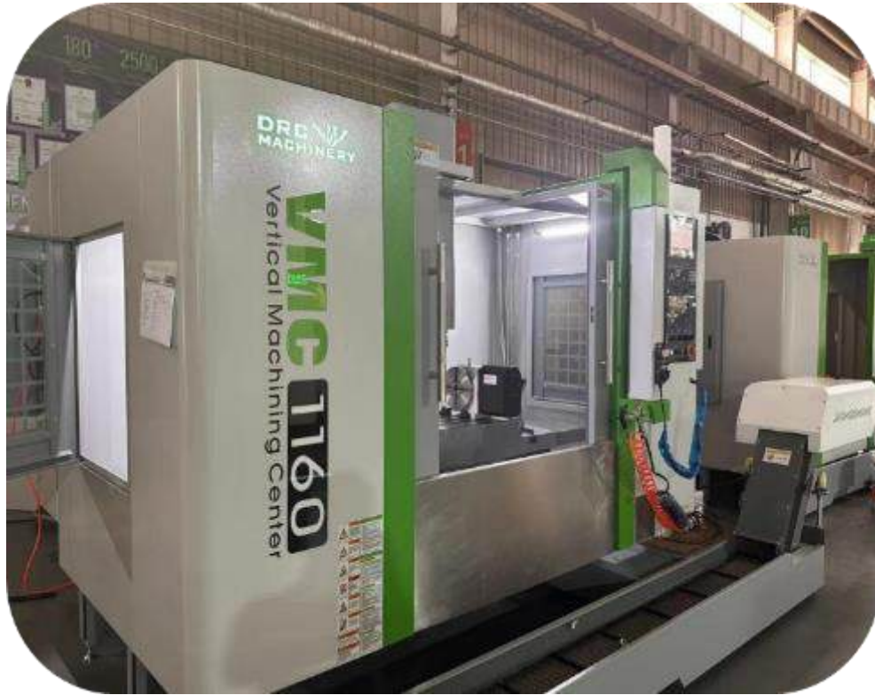
Вертикальный обрабатывающий центр модели VMC 1160
